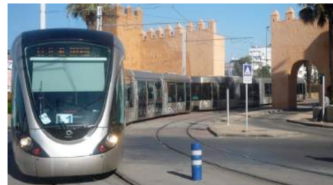
Figure 4 : Tramway de Rabat, du constructeur Alstom (65 mètres, jusqu'à 580 passagers)
